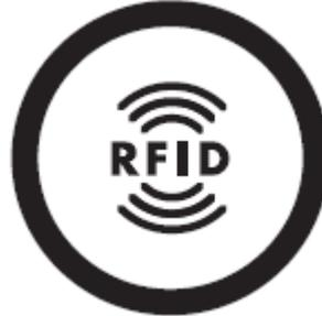
Es können handelsübliche RFID-Transponder mit einer Frequenz von 13,56 MHz und dem Protokoll MIFARE verwendet werden.
